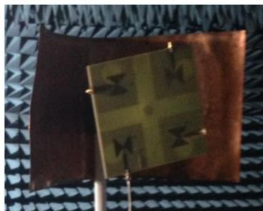
Gambar 3.29 Pengukuran Gain Dengan Menggunakan Corner Reflektor 90°
