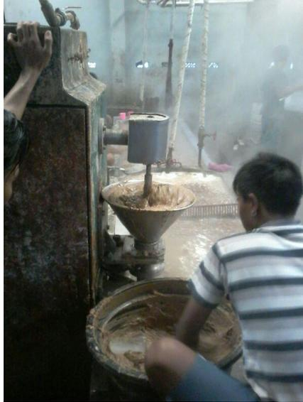
Gambar II.21 Proses Pembentukan Bakso Menggunakan Mesin
