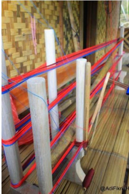
Gambar III. 34 Alat Untuk *Ngantéh*
