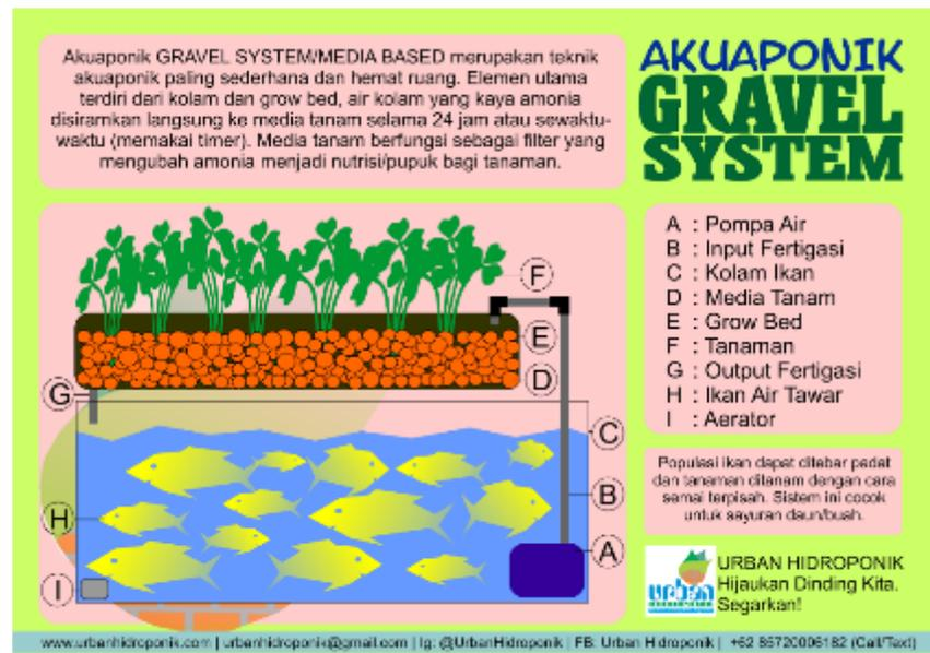
Gambar II.2: ilustrasi sistem kerja bak kerikil
