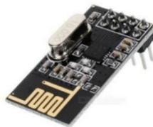
Gambar 2.3 Modul Komunikasi NRF24L01
