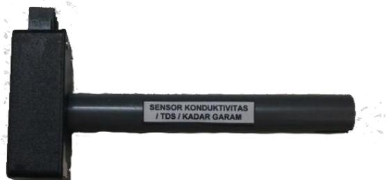
**Gambar 2.5** Sensor Konduktivitas Air [24]
